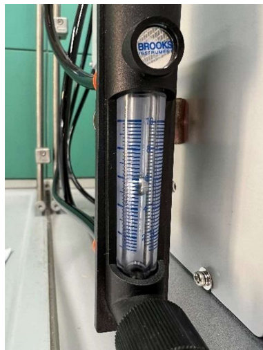
Figura 3. Misuratore flusso di N 2 , posizionato sulla sinistra dello strumento, vicino al tasto di accensione. Subito dopo aver aperto la manopola dell'N 2 , controllare sempre il livello. Se risulta più basso di 5 L/min girare lentamente la manopola e impostare il flusso a 5 L/min, come riportato nell'immagine.
