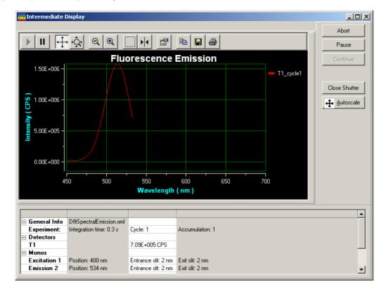
Il massimo numero di conteggi di fotoni al secondo in cui il rivelatore (un tubo fotomoltiplicatore) ha ancora una risposta lineare è di 2.000.000 cps. Se il valore misurato dovesse essere maggiore è consigliabile chiudere le fenditure, in modo da diminuire l'intensità della radiazione che raggiunge il rivelatore.
