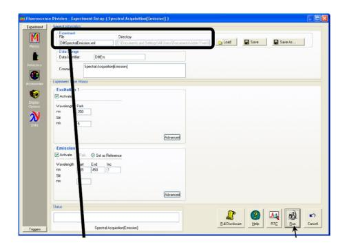
In alto a sinistra possiamo scegliere il nome del file che andremo ad acquisire. Selezioniamo poi i parametri sperimentali, sia per quanto riguarda la lunghezza d'onda di eccitazione che per quanto riguarda l'intervallo di lunghezze d'onda da andare ad acquisire in emissione. In questa schermata è possibile andare anche a selezionare la larghezza delle fenditure dei due monocromatori, quello di eccitazione e quello di emissione, in termini di banda passante (nm).
