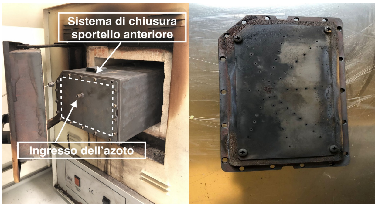
Figura 2 – Vista generale del reattore di pirolisi (A) e particolare dell'elemento di chiusura del reattore (B) dotato di sistema di erogazione a raggiera dell'azoto
