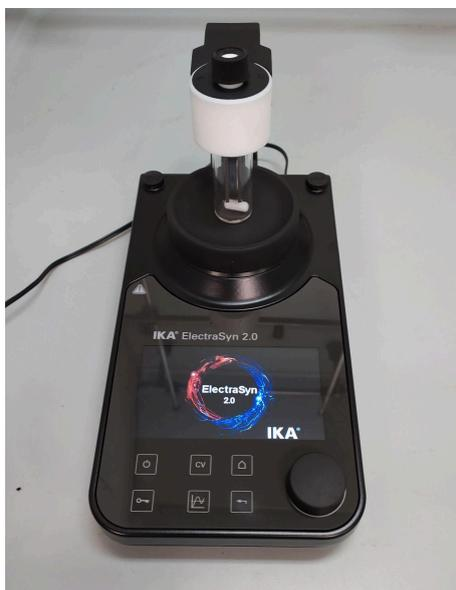
Fig1. ElectraSyn 2.0 con supporto per fiala singola.
