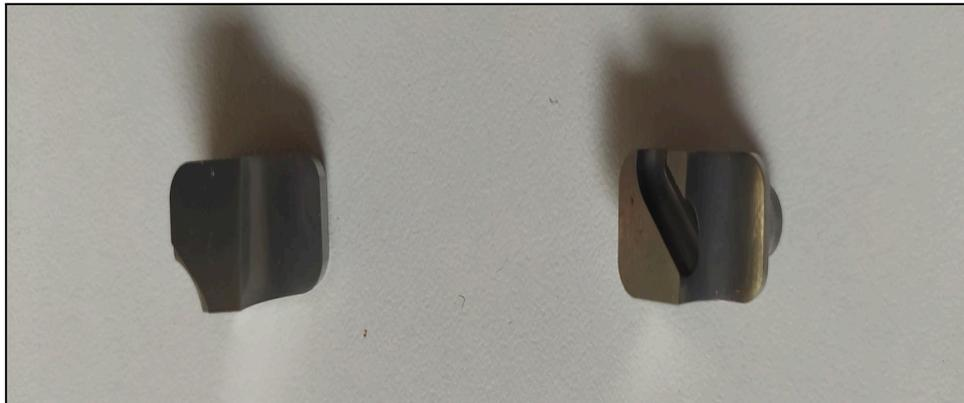
**Figura 8.** Sinistra: Stop superiore, da inserire al posto del tassello cerchiato in verde in figura 7C. Destra: Deviatore del loop, da inserire al posto del tassello cerchiato in giallo in figura 7C.
