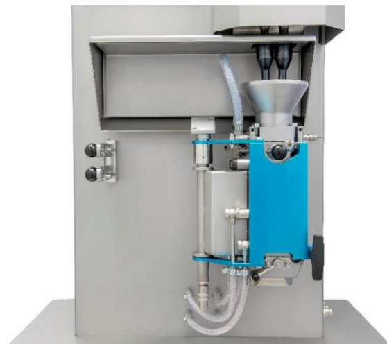
Figura 4: piastre di raffreddamento ad acqua contro la canna
